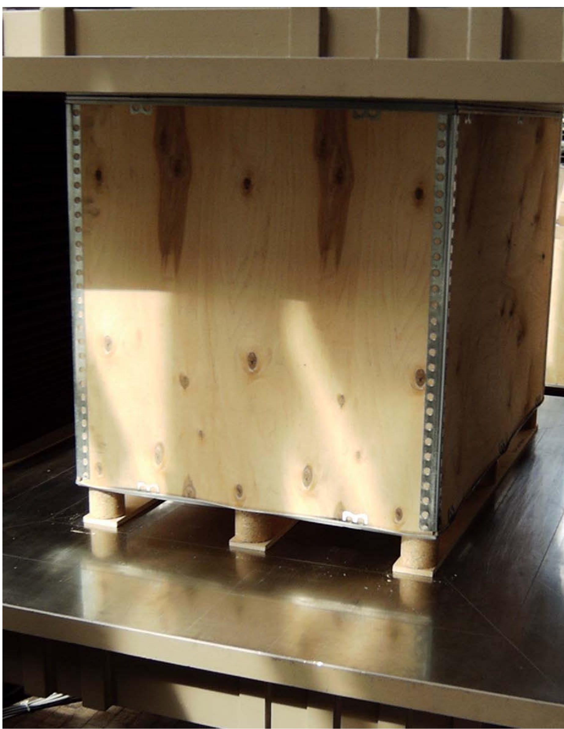
Stapeldruckprüfung zur Simulation eines drei Meter hohen Stapels gleicher Packstücke.
