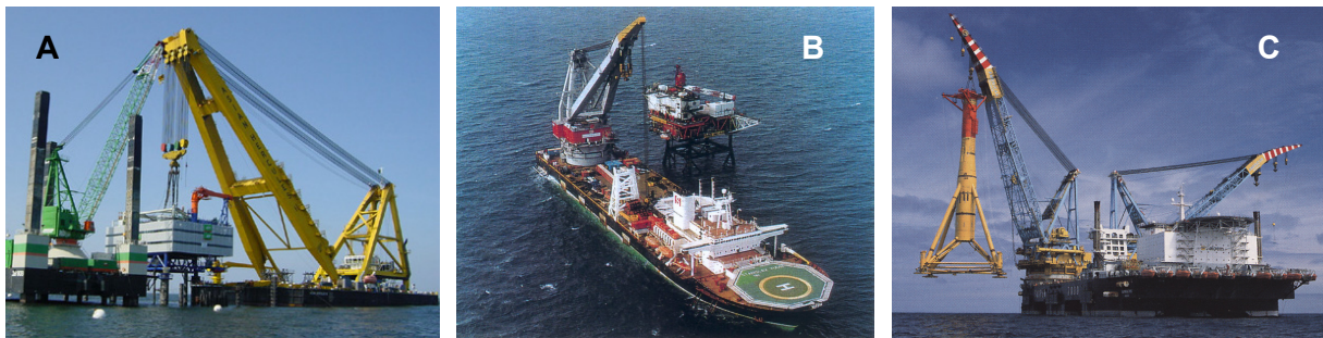
Abb. II.1.5-8: Offshore-Schwimmkräne A: Sheerleg-Kranbarge (Smit International, Asian Hercules II, 3.200 t) B: Kranschiff (Seaway Heavy Lifting, Stanislav Judin, 2.500 t) C: Kranhalbtaucher (Saipem, S 7000, 2 x 7.000 t)
