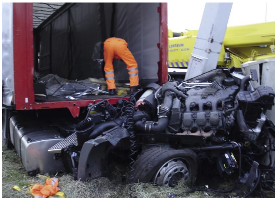
Aufnahme vom Unfallort: Das Führerhaus riss aus den Verankerungen des Fahrgestells
