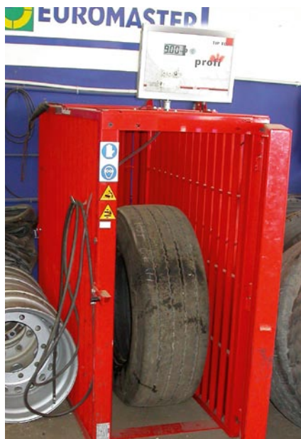
Die Befüllleinrichtung mit Computer bietet optimalen Schutz vor wegfliegenden Teilen
