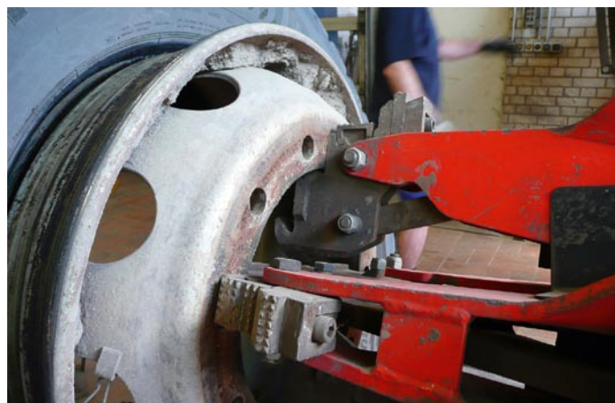
Fotos rechts: Formschlüssige Sicherung auf einer Reifenmontiermaschine mittels Schrauben und Klauen
