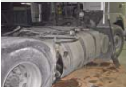
Bei der Explosion riss dieser Kraftstofftank.
