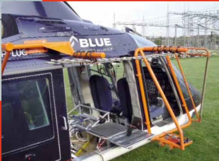
Ein Vorteil der Agusta A 109 besteht darin, dass ihr Heckrotor links vom Leitwerk angebracht ist und damit bei Montageflügen auf der den Freileitungen abgewandten Seite liegt.
