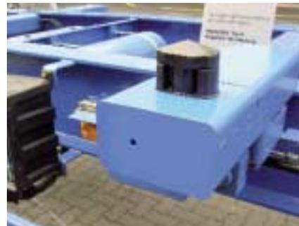
Trailer mit automatischer Containerverriegelung, oben der Steuerstand an der Fahrzeuglängsseite und unten die geöffnete Containerverriegelung im Detail.
