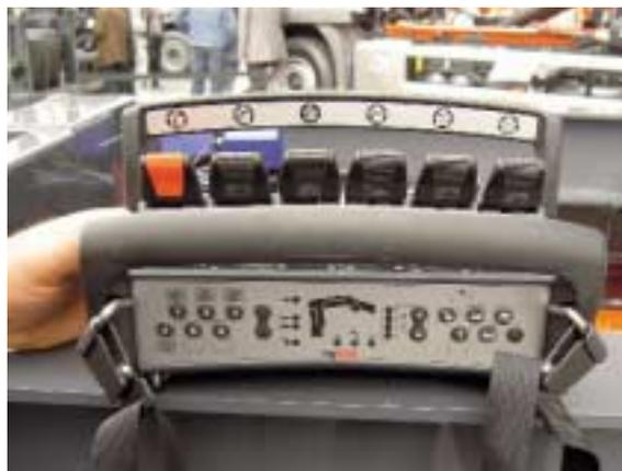
chenden Stelle des Auslegers anzeigen. Unterhalb 90 Prozent Auslastung leuchten die Anzeigen grün. Steigt die Auslastung über 90 Prozent, wechselt die Anzeige von grünem auf gelbes Licht. 100 Prozent Auslastung wird durch rotes Licht angezeigt, am Kran ertönt dann ein akustisches Warnsignal und der Kran wird abgestellt. Jetzt sind nur noch das Lastmoment verringern- und die Bewegungen des Kranauslegers möglich.
