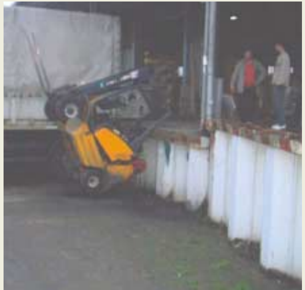
Absturz eines Gabelstaplers von der Ladefläche eines Anhängers. Das Fahrzeug war nicht gegen Wegrollen gesichert.
