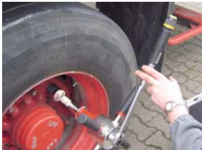
Lösung der Radmuttern mit nur zwei Fingern.
