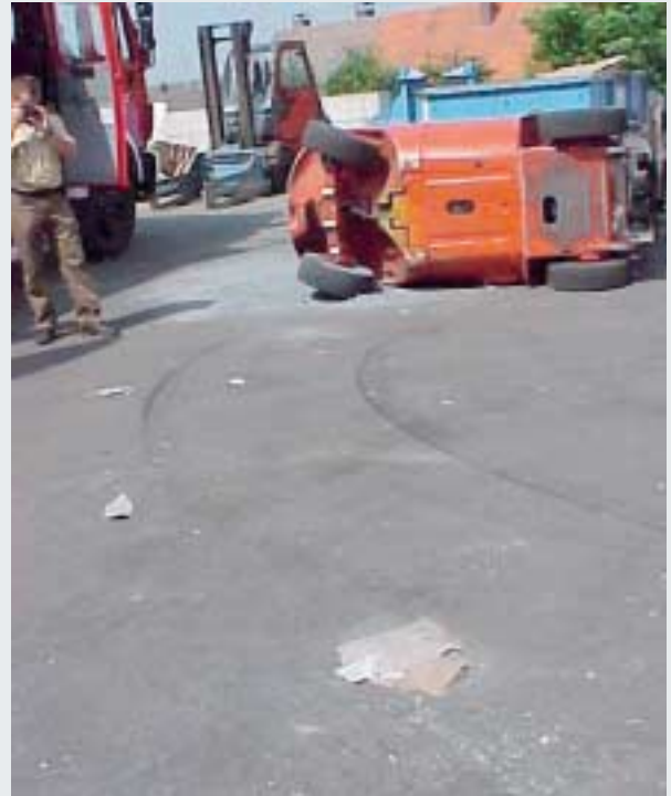
Die Spuren der Kurvenfahrt sind noch zu erkennen. Der Stapler kippte nach links um, der Fahrer wurde schwer verletzt.
