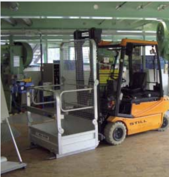
Mit der gesicherten Arbeitsbühne können auch Personen hochgefahren werden.
