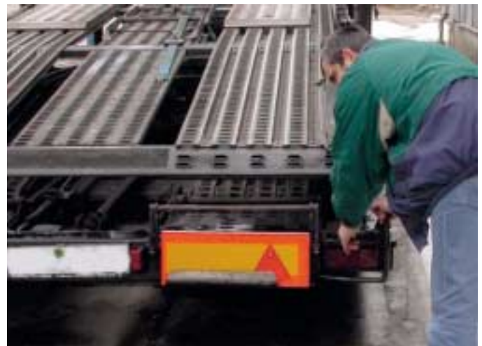
Mehr Sicherheit und weniger Stress: Die Bedieneinheit zum Ausfahren der Rampen liegt jetzt auf der rechten Seite.
