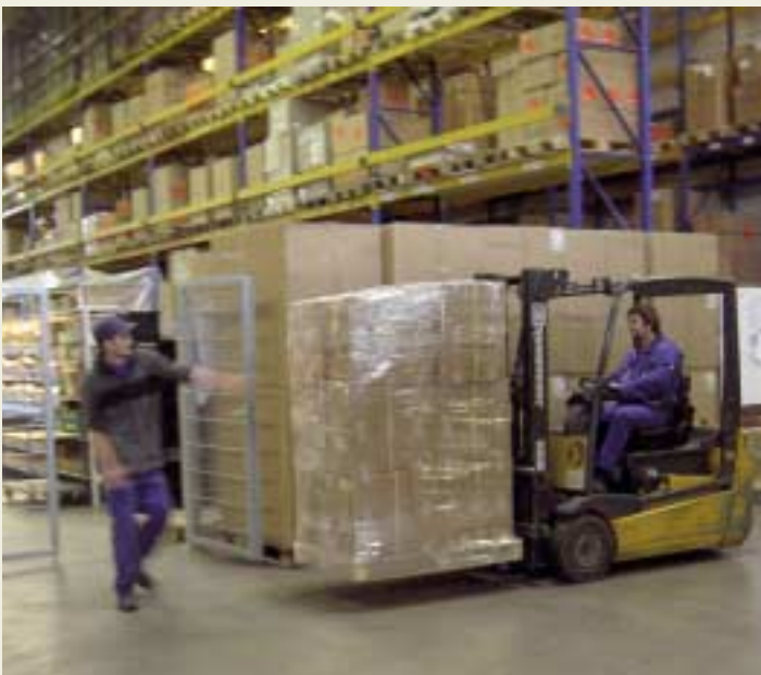
So nicht! Bei zu hoher Last muss der Fahrer rückwärts fahren.
