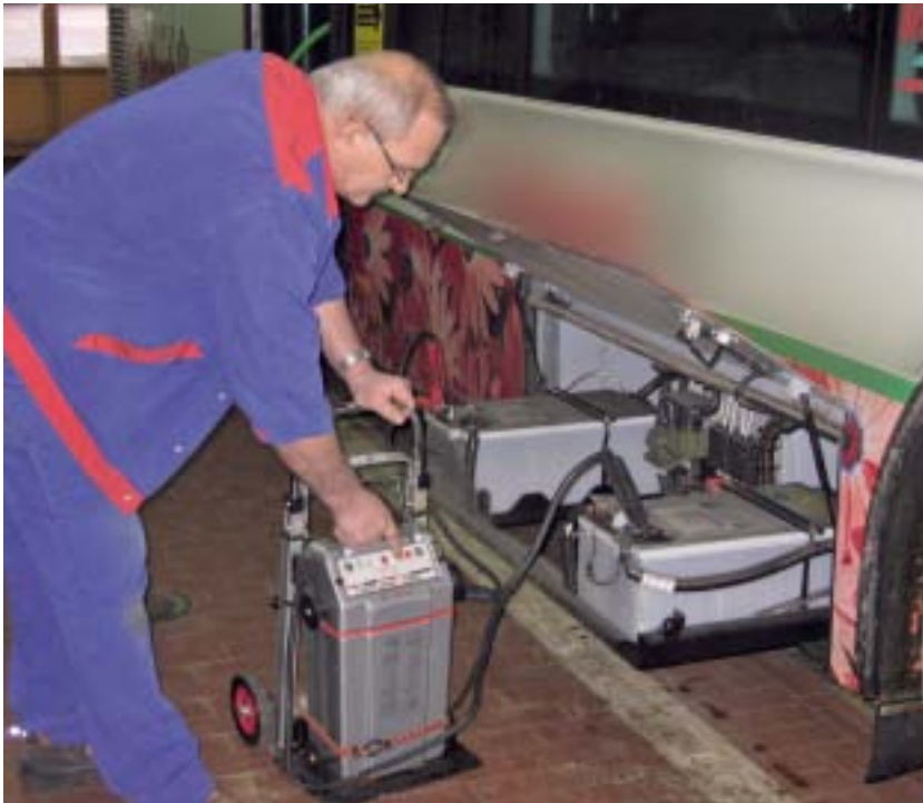
Sichere Fremdstarthilfe an einem Bus mittels „Power Pack“
