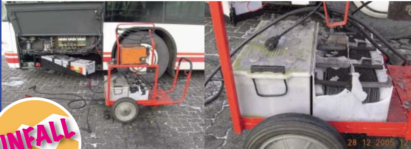
Die 12-Volt-Batterie der Starthilfeeinrichtung nach der Explosion. (Fotos: Kripo Borken)
