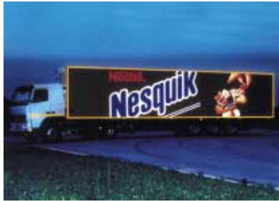
Besser erkennbar: Lkw mit retroreflektierender Konturmarkierung
