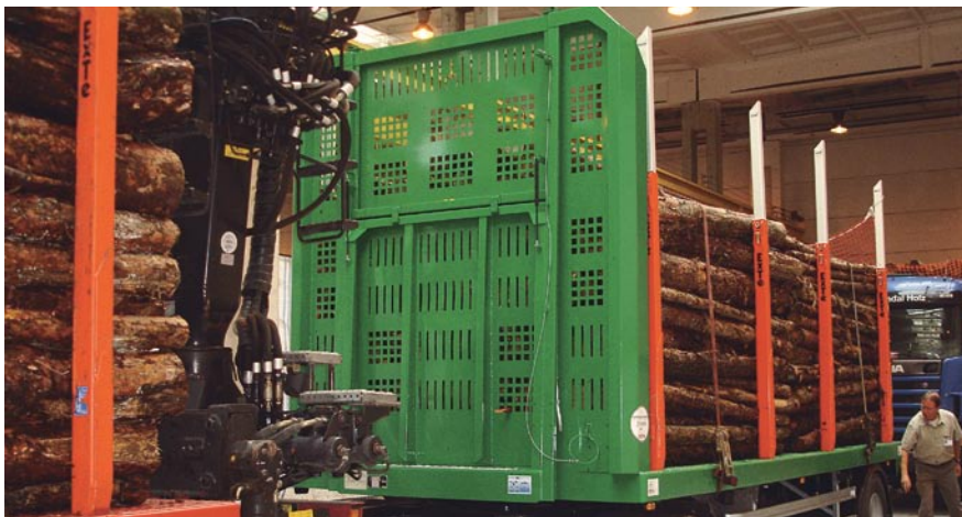
Oben: Klappbare Stirnwand Unten: Netzkonstruktion als Rückhalteeinrichtung
