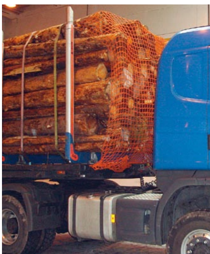
Oben: Klappbare Stirnwand Unten: Netzkonstruktion als Rückhalteeinrichtung
