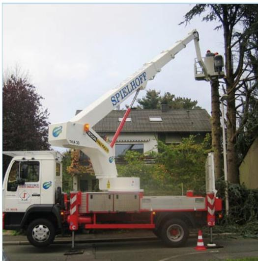
Lkw-Arbeitsbühnen sind besonders geeignet für häufig wechselnde Einsatzorte. Sie ermöglichen eine hohe Korbbelastung. Die Arbeitshöhen können bis zu 100 Meter, die seitlichen Reichweiten bis zu 40 Meter betragen.
