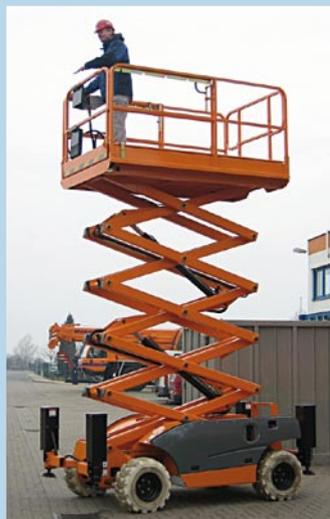
Scheren-Arbeitsbühnen haben im Verhältnis zur Gerätegröße eine große Arbeitsplattform. Sie sind kompakt und verfügen über große Tragfähigkeiten. Scheren-Arbeitsbühnen sind je nach Ausführung für Innen- und Außeneinsätze geeignet.
