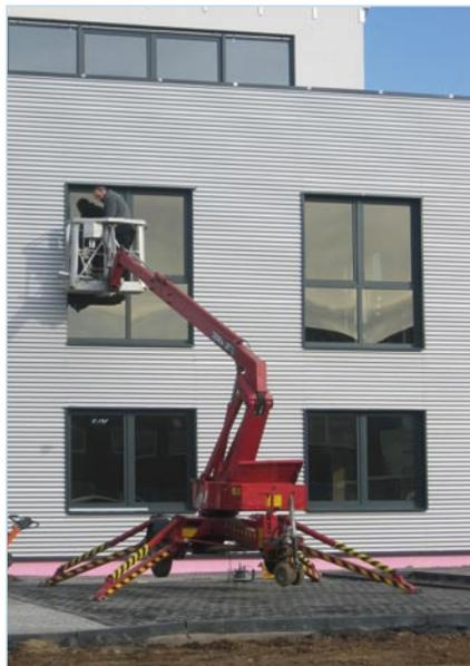
Anhänger-Arbeitsbühnen eignen sich besonders für Einsätze mit schmalen Durchfahrtsbreiten und -höhen. Sie eignen sich für den Eigentransport zum Beispiel mit dem Pkw und verursachen am Aufstellungs-ort nur eine geringe Bodenbelastung.
