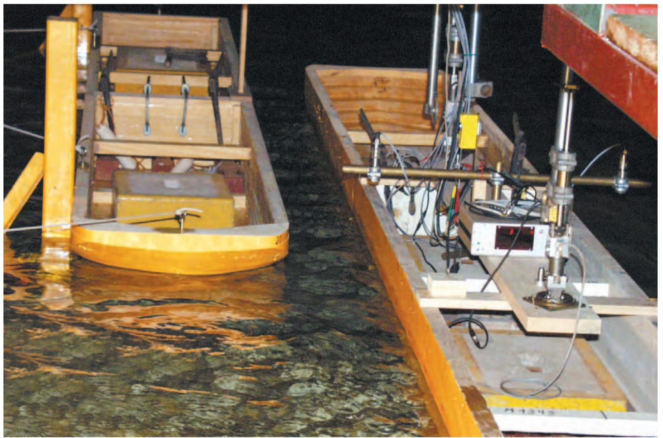
Versuch zu Kraftmessungen bei Überholvorgängen.
