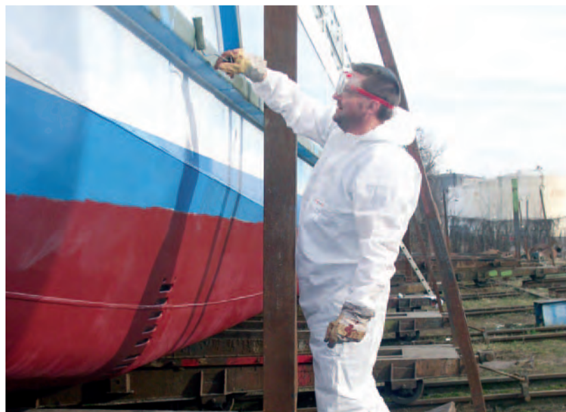
Beim Umgang mit Farben die Verarbeitungshinweise des Herstellers beachten – und Haut und Augen schützen.
