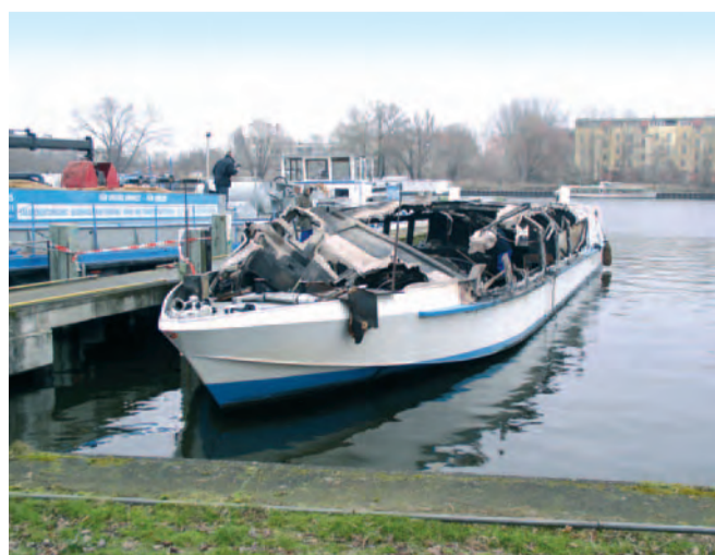
Die Aufbauten der „Marlene“ sind vollkommen verbrannt.
