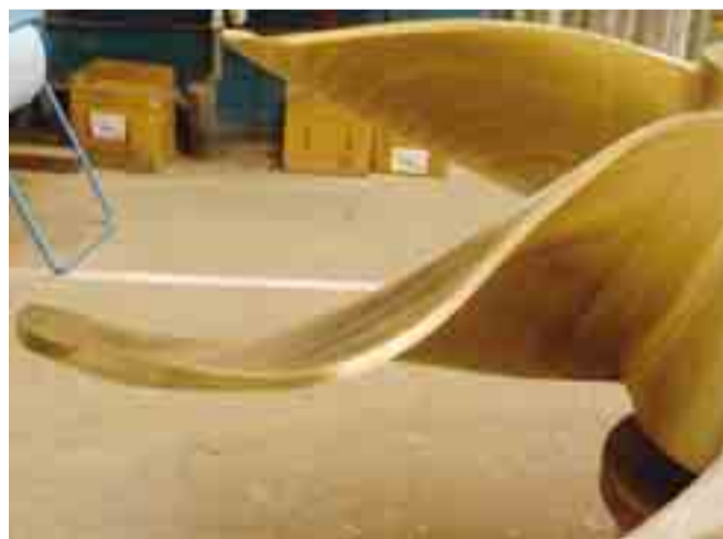
Mit dieser Form des Propellers wird der Wirkungsgrad deutlich erhöht.
