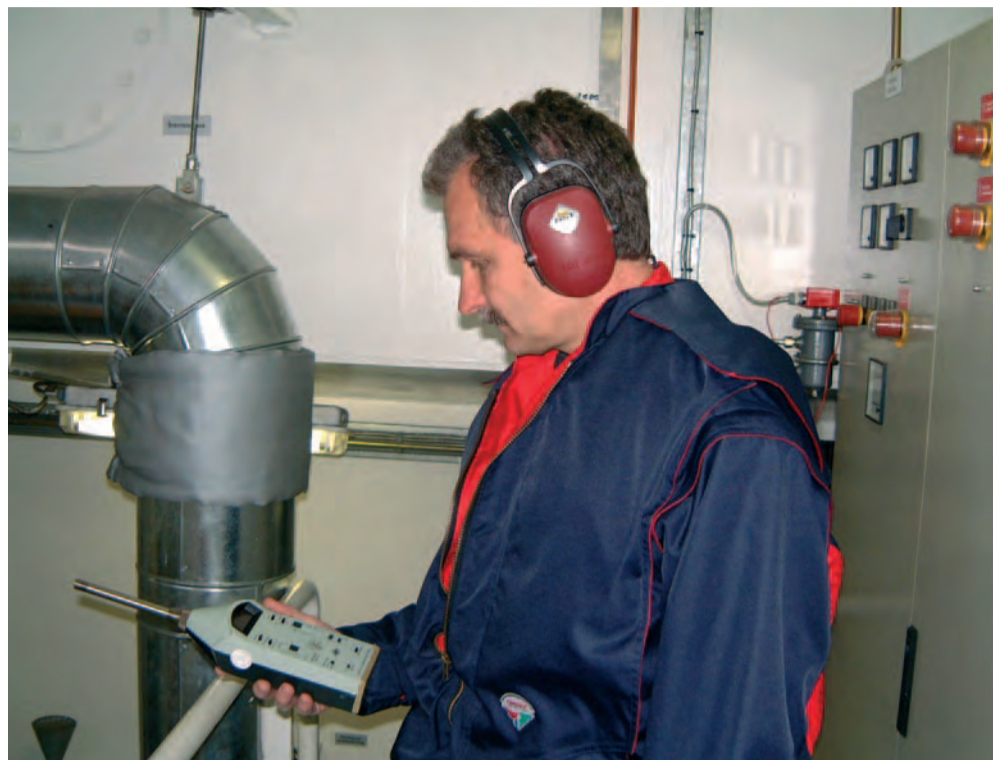
Im Bedarfsfall – wie hier bei einer Schallpegelmessung – sind Fachleute hinzuzuziehen.
