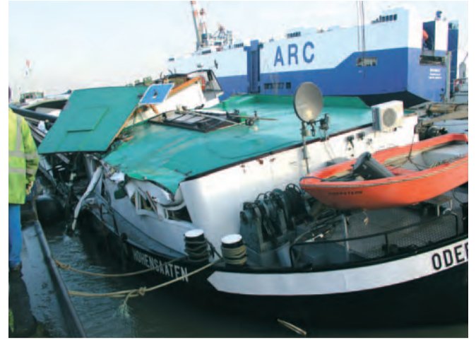
Die „Oderstern“ wurde stark beschädigt, das ganze Schiff hat sich verzogen.
