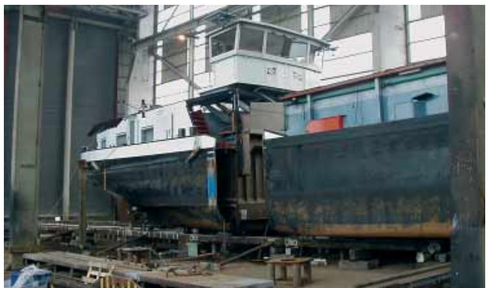
Die Trennung von Heck und Mittelschiff erfolgte in der Schiffbauhalle.
