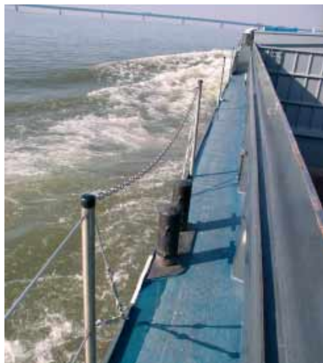
Gangbordgeländer und ein hohes Schanzkleid ermöglichen einen sicheren Gang.
