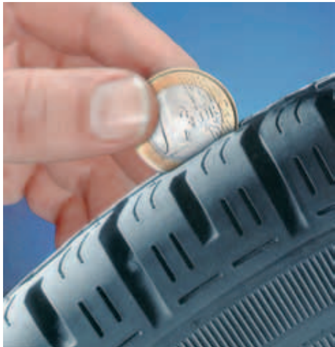
Der Härte-test mit dem Euro. Mindestprofil-tiefe: Der Goldrand muss verdeckt sein.
