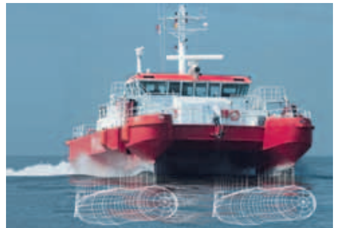
Zwei Tauchkörper aus Alüstar sorgen für ein optimales Schwimmverhalten des Lotsenschiffs.
