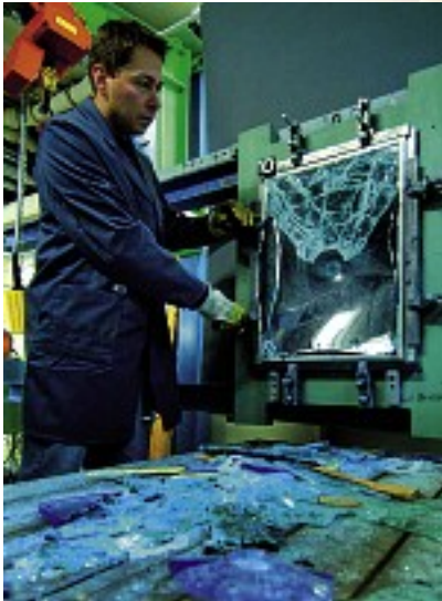
Die Schutzscheibe nach Beschussprüfung
