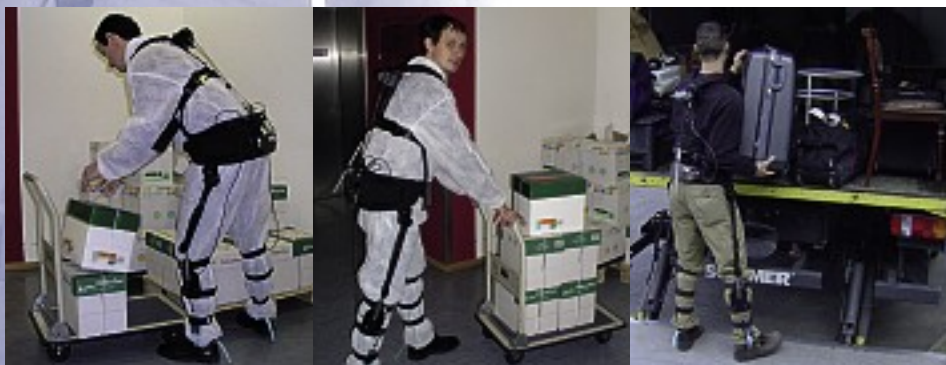
Bequem sind die Messinstrumente nicht – Datenerhebung beim Heben und Tragen
