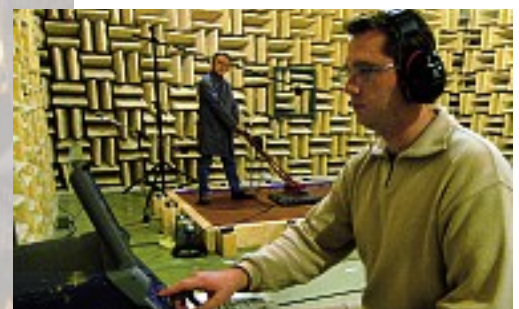
Lärmmessung an einem Rollenrüttler
