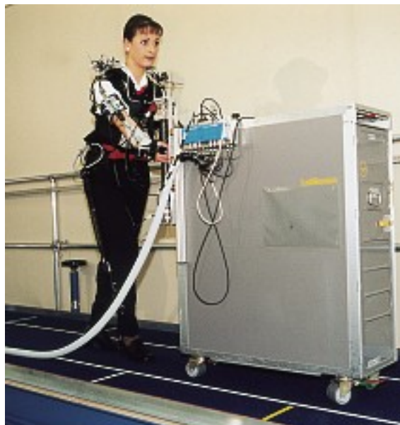
Mit Mess-Sensoren gespickt schiebt diese Flugbegleiterin einen Trolley über eine schiefe Ebene.
