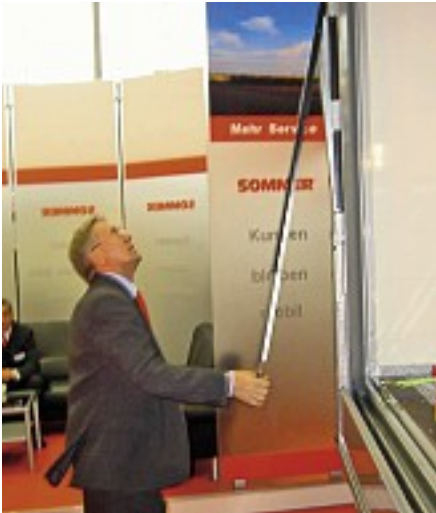
Vom Boden aus kann durch „Pumpbewegungen“ des Hebels die Dachkonstruktion ohne großen Kraftaufwand angehoben werden.
