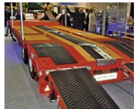
Die Auffahrampen sind mit dem „superGRIP“-Wellenprofil beschichtet, die Ladefläche besteht aus Holz. Der Tieflader kann aber auch durchgehend mit dem Wellenprofil ausgestattet werden.
