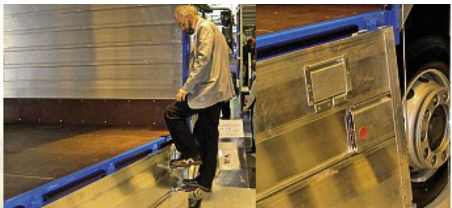
Die Ladefläche des Fahrzeuges kann bequem und sicher betreten und verlassen werden. Die Tritte werden mit einem einfachen Handgriff herausgeschwenkt.
