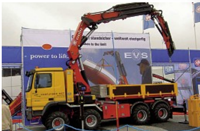
An dem ausgestellten Fahrzeug montierte die Firma HMF einen „Winkelmesser“, um die Veränderung der Fahrzeugneigung sichtbar zu machen.
