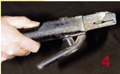
Bild 4: „Stark abgearbeiteter“ Elektrodenhalter
