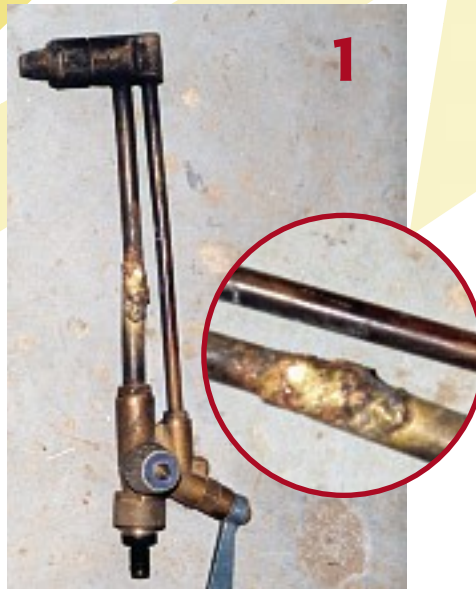
Bild 1: „Reparierter“ Schneidbrenner Bild 2: „Anwämbrenner“ vom Typ Eigenbau
