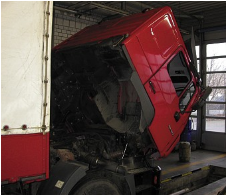
Die Kabine ist bis in die Endstellung gekippt und befindet sich in einer sicheren Lage
