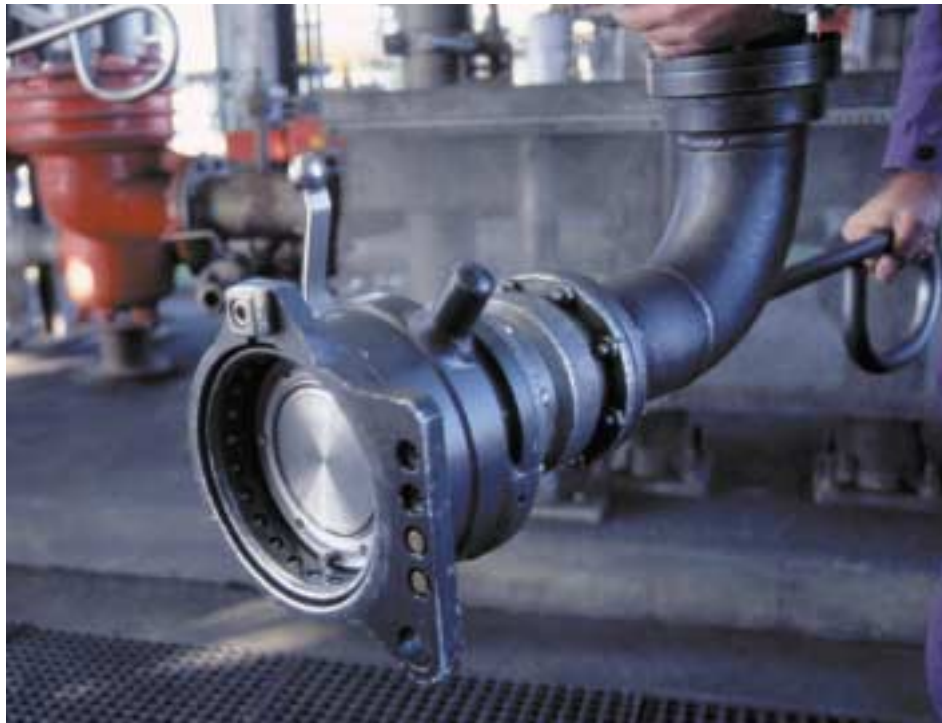
Interessante Technik: Landseitiger Teil der Trockenkupplung für Bottom Loading.
