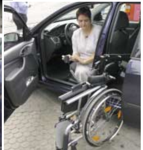
Per Fernbedienung öffnet sich die hintere Tür, die Verladehilfe wird aktiviert, nimmt den Rollstuhl auf und zieht ihn hinter den Rücksitz
