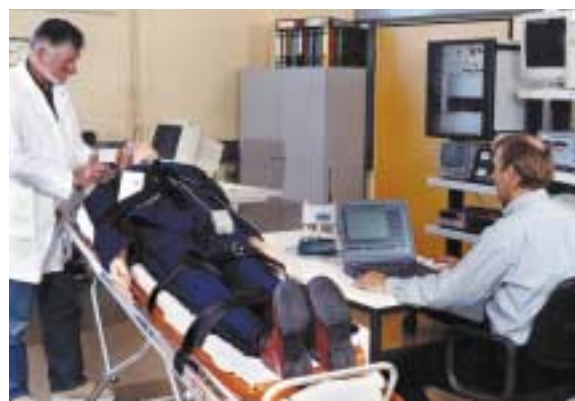
Die 80 kg schwere Rettungspuppe auf einer Trage im BAuA-Labor ist mit Berührungssensoren ausgerüstet und wird im Versuchsparcours eingesetzt
