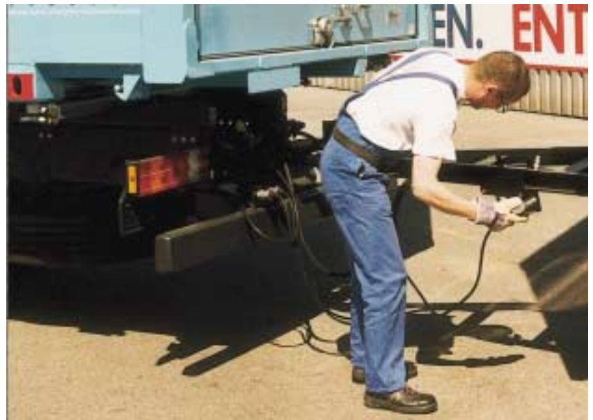
Klarer Arbeitsablauf: Erst das Zugfahrzeug mit der Feststellbremse festsetzen, dann die Verbindungsleitungen anschließen
