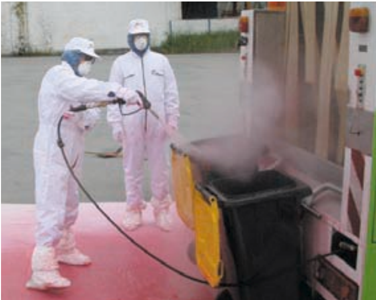
Durch Einfärbung wird bei einer Geräteprüfung die Reichweite und Verteilung des Spritzwassers sichtbar gemacht
