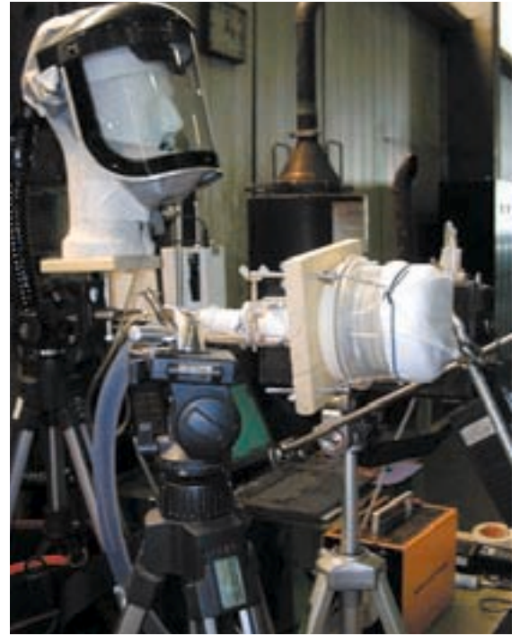
Messung der Schutzwirkung von Atemschutzgeräten gegen Mikroorganismen in einer Abfallbehandlungsanlage
