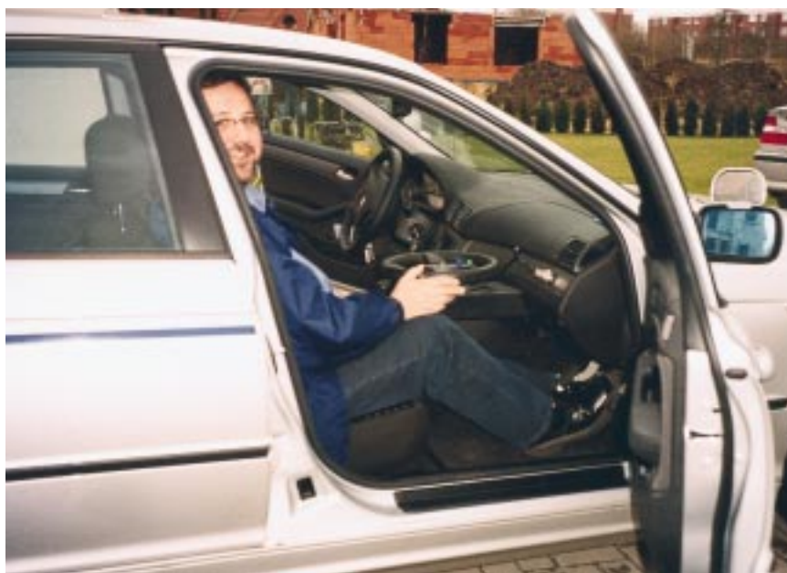
Etwas gewöhnungsbedürftig ist der Zentralkommander schon. Eine 90-Grad-Drehung am kleinen Lenkrad bewirkt den vollen Einschlag des Steuers auf der Fahrerseite
