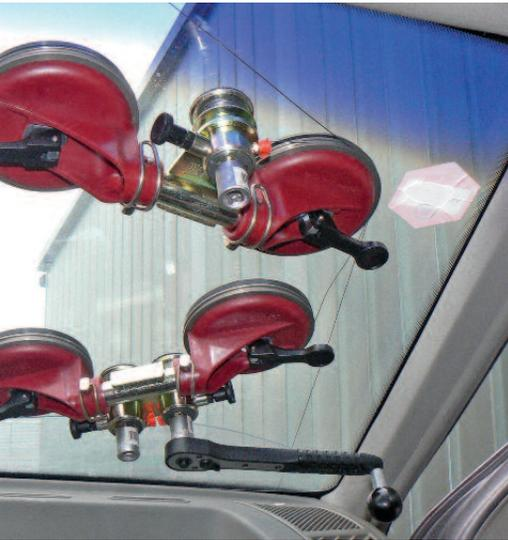
Mit Hilfe der mit Saugnäpfen auf der Scheibe montierten Kurbel kann der Schneidedraht ohne großen Kraftaufwand durch die Klebmasse gezogen werden.
