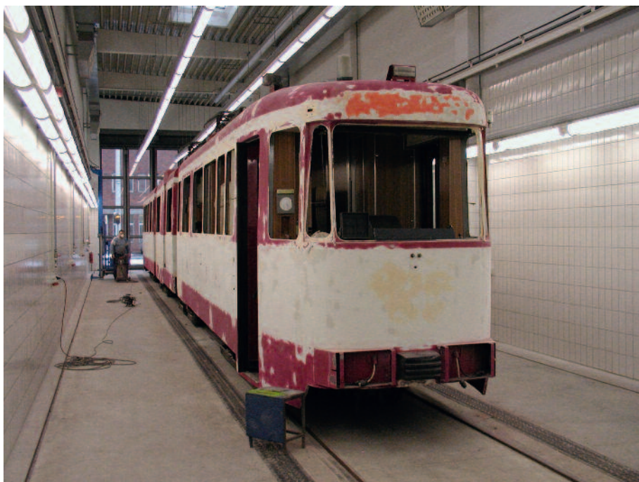
Lackierarbeiten sind häufig nach Unfällen im Rahmen der Hauptuntersuchung oder bei Fahrzeugmodifikationen erforderlich. Dabei können auch größere Mengen von isocyanathaltigen 2K-Lacken verarbeitet werden.
