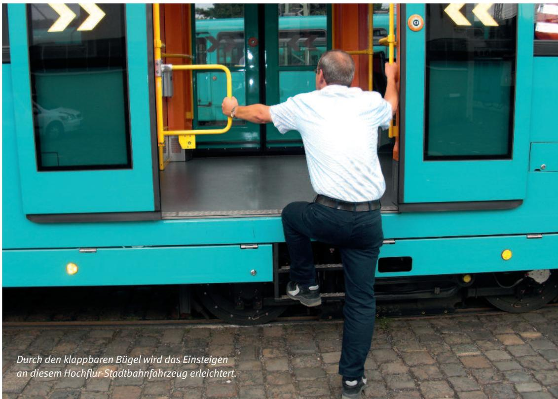
Durch den klappbaren Bügel wird das Einsteigen an diesem Hochflur-Stadtbahnfahrzeug erleichtert.
