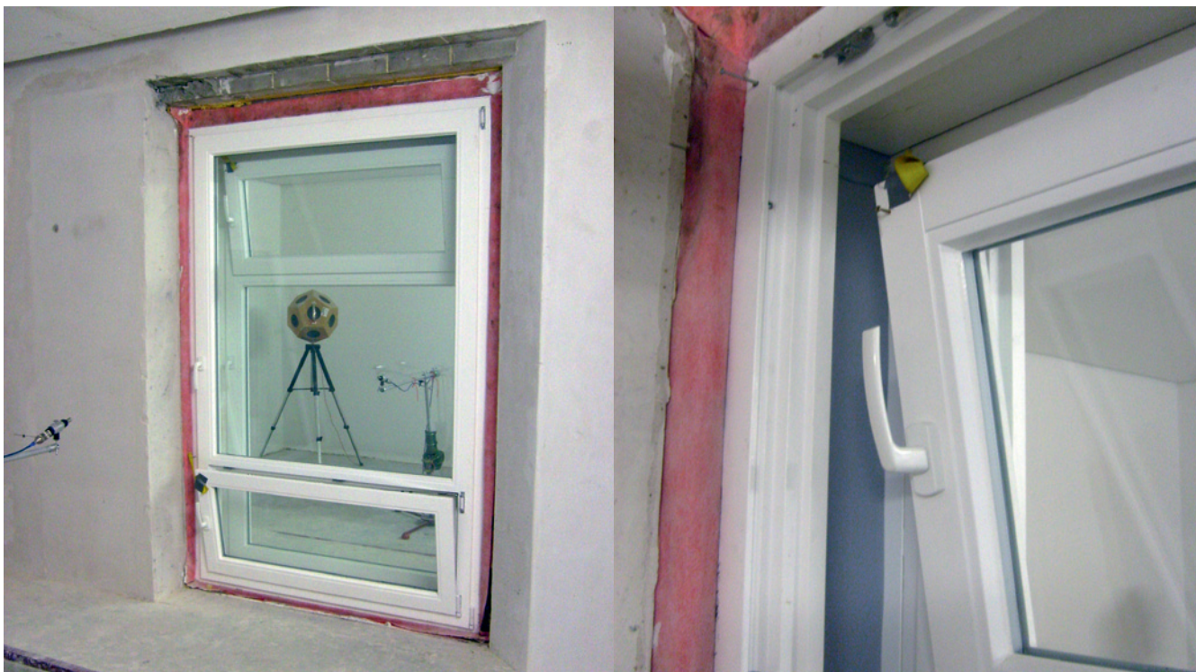
Bild 10: Laborfotos der Messungen am „HafenCity-Fenster“
