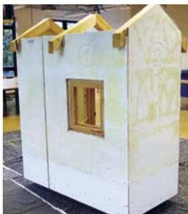
Modell für Wärmedämmarbeiten
