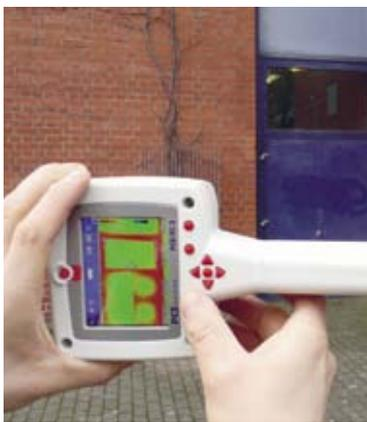
Die Wärmebildkamera zeigt Wärmebrücken
