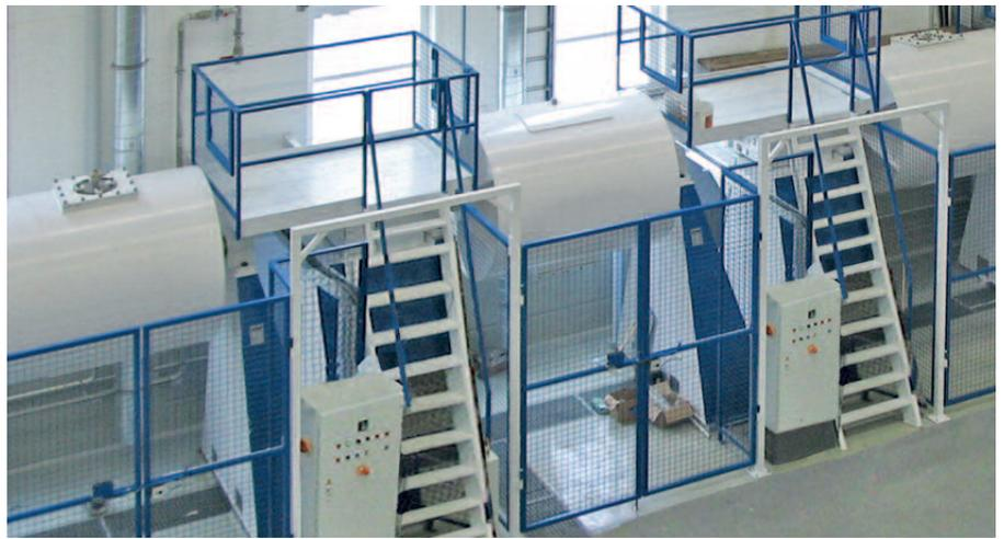
Für neuere Trommelmühlen gelten die Maschinen- und die Betriebssicherheitsverordnung – auch ältere Modelle sollten besonders gesichert werden.
