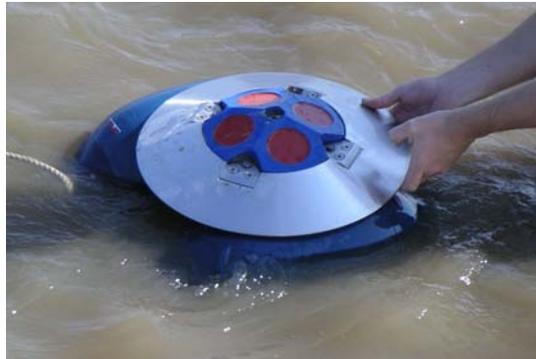
**Abbildung 3.1:** ADCP-Gerät mit Edelstahlring
