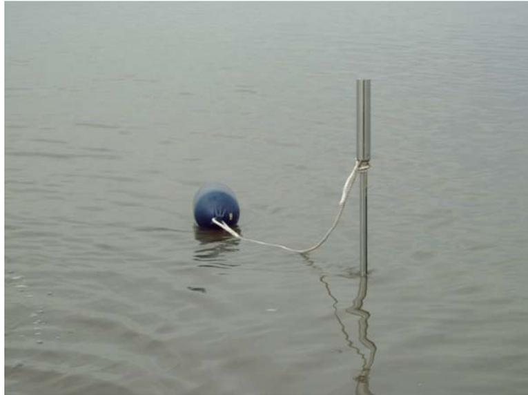
**Abbildung 3.4:** Trübungsmessgerät ASM im Einsatz
