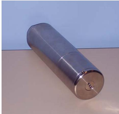
**Abbildung 3.6:** Drucksonde P-LOG521-MMC
