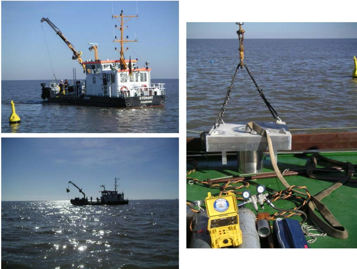
**Abbildung 2.9:** Einsatz der Störort zum Ausbringen der ADCP-Geräteträger und der Tonnen
