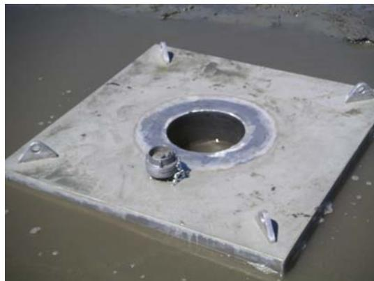
**Abbildung 3.2:** ADCP-Geräteträger
