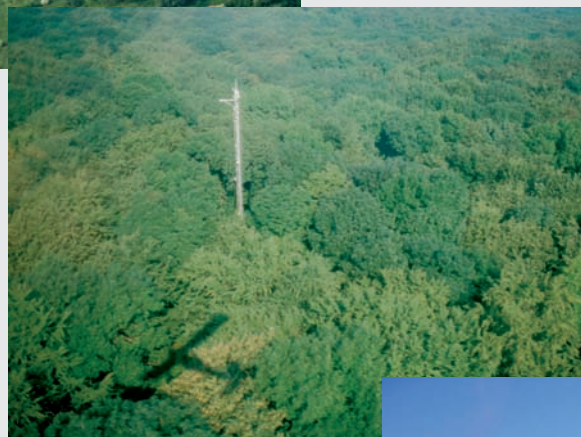
Abb. 10. Messturm im Nationalpark Hainich (Nordthüringen), an welchem kontinuierlich die vertikalen Austauschflüsse von \text{CO}_2 und Wasserdampf zwischen Atmosphäre und Landvegetation bestimmt werden.
