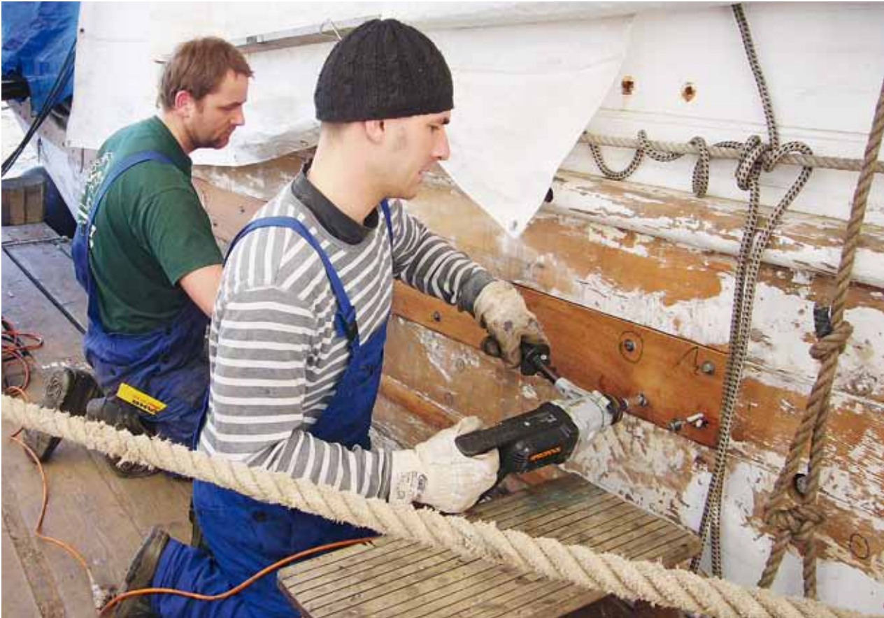
Reparaturarbeiten am Holzrumpf des 128 Jahre alten Lotsenschoners N°5 ELBE auf der Werft in Harburg
