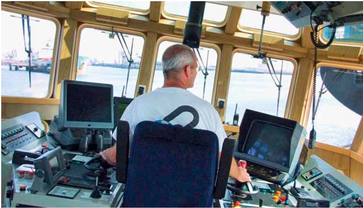
Bugsieren mit dem Joystick: Die Ein-Mann-Kommando-„Brücke“ des Hafenschleppers ist heutzutage ein Hightech-Arbeitsplatz.
