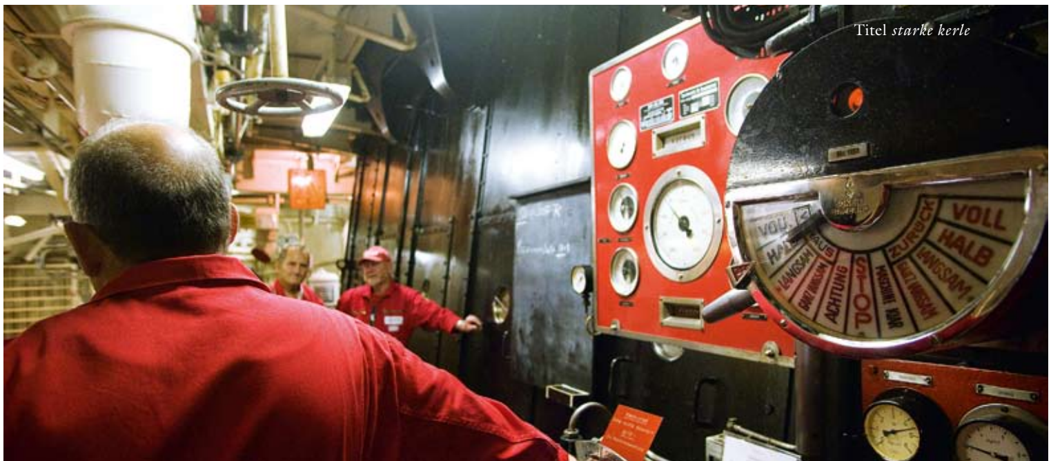
Der Maschinentelegraf übersetzt die Befehle von der Brücke: Unter der Wasserlinie müssen die Anweisungen blind nachvollzogen werden – hier zählt nur das Vertrauen in die Schiffsführung.
