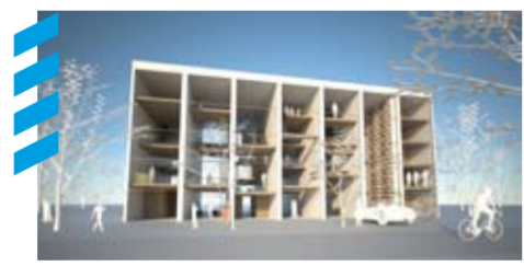
Das moderne „Stecksystem“ Querkraft Architekten ZT GmbH, Wien, GriffnerHaus AG Geschossfläche: ca. 2.435 m 2 , Geschosse: 3-5
