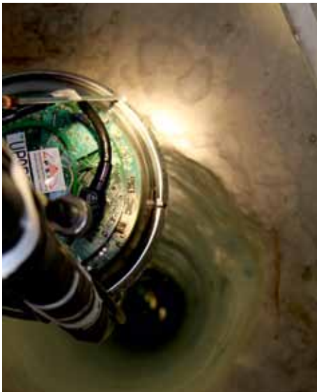
Ein Digitales Optisches Modul wird ins Eis am Südpol herabgelassen.
