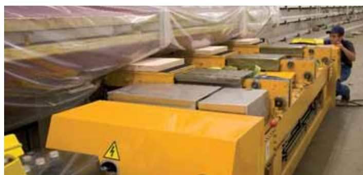
Keine Einparkprobleme: Mit dem beweglichen „Dwarslöper“ (Querläufer) werden die 200 etwa 8 Tonnen schweren Dipole aus dem Tunnel befördert.
