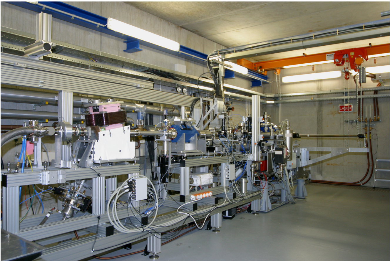
Abbildung 102: Ansicht des Photoinjektor-Teststandes bei DESY Zeuthen (PITZ).
