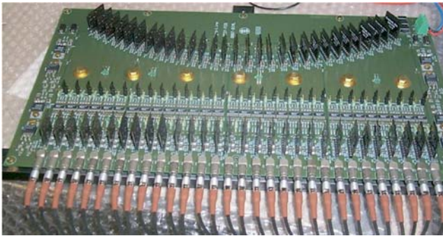
Abbildung 89: 30-Kanal pyroelektrischer Detektor. Die Sensoren sind halbkreisförmig angeordnet. Die Spektrometeranordnung befindet sich in einem evakuierten Behälter in der Fokalebene der im Jahresbericht 2005 beschriebenen THz-Strahlführung.
