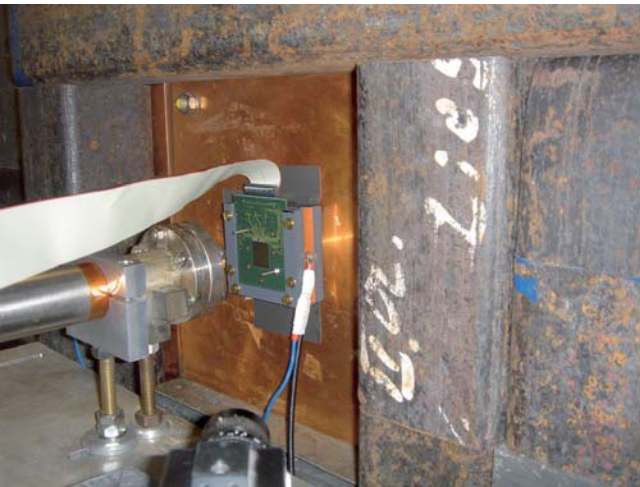
Abbildung 74: Ein MAPS Chip während der Bestrahlung mit Elektronen bei der GSI in Darmstadt
