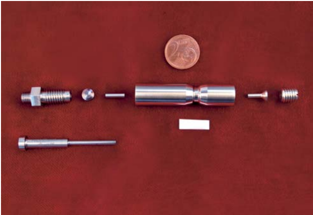
Abbildung 156: Probendruckzelle, HASYLAB (ZM32). Unten rechts (weißes Rechteck) der Teflonbehälter für Proben.
