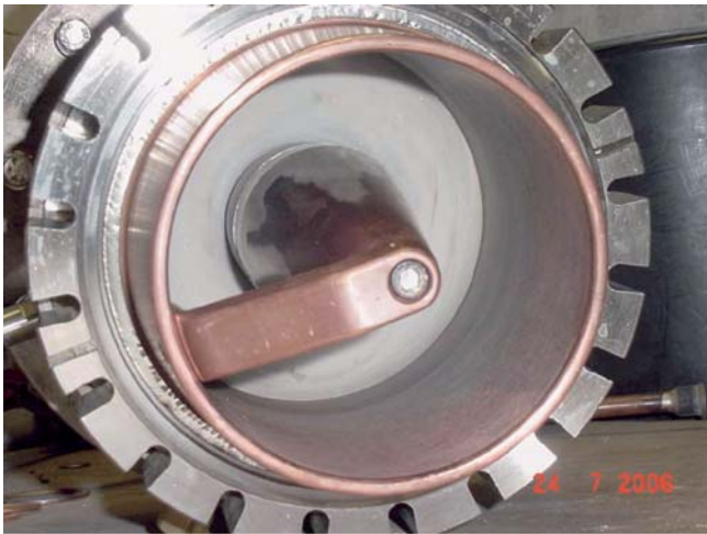
Abbildung 120: Cavity-Einkopplung vom Typ PETRA. Typisches Bild eines während der Konditionierung gescheiterten Kopplers. Die grauen Stellen auf dem Mittelleiter stammen vom überschüssigen Silberlot einer Lötung nahe der Keramik. Dort wurde durch Überschläge Material abgetragen, welches sich dann als grauer Schleier auf der Kupferoberfläche des Außenleiters und in Schlierenform auf der Keramik des Vakuumfensters abgelagert hat.
