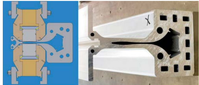
Abbildung 125: Profil der Undulatorvakuumkammer: CAD Model (links) und stranggepresstes Aluminiumprofil (rechts). In der Mitte befindet sich die flache Öffnung für den Elektronenstrahl, rechts sieht man den Pumpkanal. Die runden Bohrungen sind für die Wasserkühlung.
