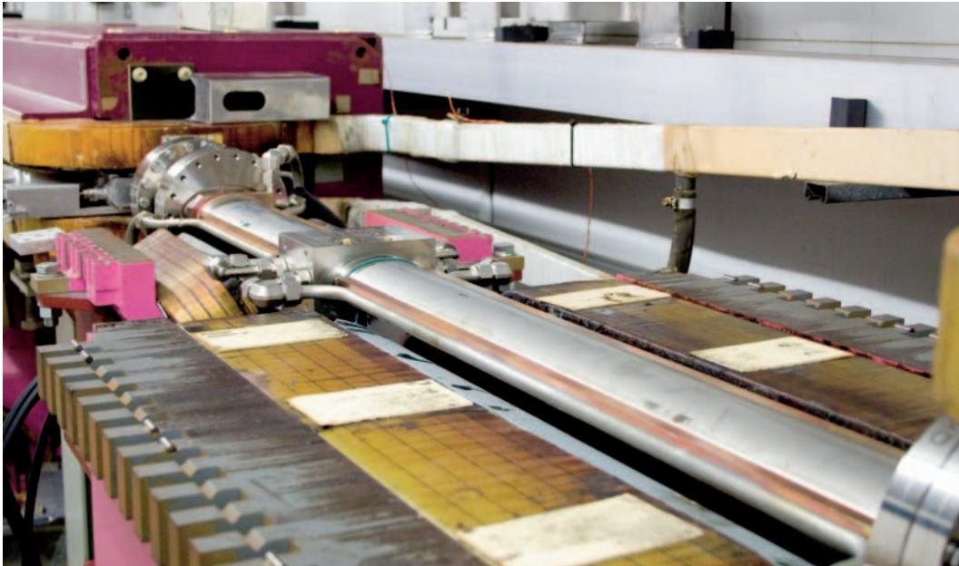
Abbildung 107: Systemtest für das neue Vakuumsystem in PETRA II. Abgebildet ist die eingebaute Vakuumkammer aus elliptischem Edelstahlprofil in den noch geöffneten Quadrupol- und Sextupolmagneten.
