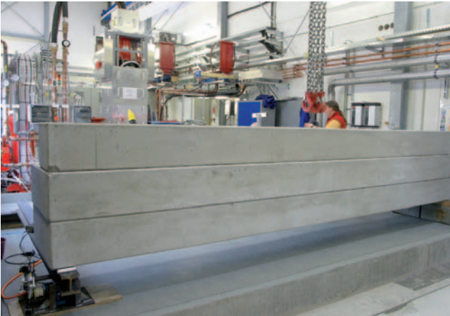
Abbildung 142: Schwerlasttest für die Justierplattform für XFEL-Undulatoren.
