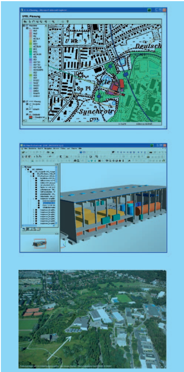
Abbildung 151: Beispiele für Visualisierungswerkzeuge: Web-GIS für die Erstellung von Karten (oben), 3D Viewer für die Prüfung von Gebäudemodellen samt Installationen (mitte), fotorealistische Visualisierung des künftigen Forschungsgeländes auf Basis von CAD-Daten (unten). Stand Jahresmitte 2005.
