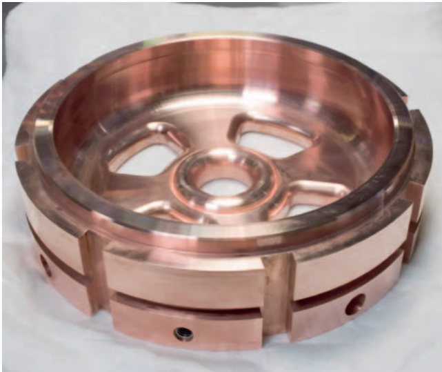
Abbildung 109: Eine der 14 Zellen der L-Band Beschleunigungsstruktur für den Einbau in PITZ.
