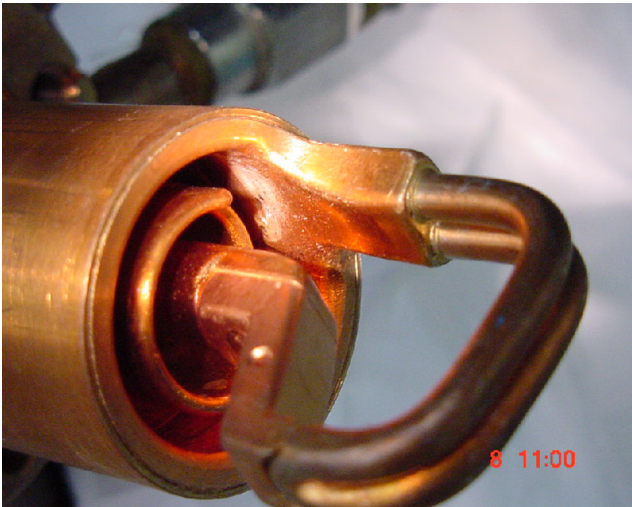
Abbildung 116: Links: Koppelschleife des ausgebauten HOM-Kopplers. Im Bereich der grauen Verfärbung, links oberhalb der Bildmitte, war das Wasser ausgetreten. Rechts: Ein Schnitt durch den Kühlwasserkanal offenbarte tiefe Erosionsspuren. Die ursprüngliche Materialdicke zwischen Wasserkanal und Vakuum betrug 1 mm.
