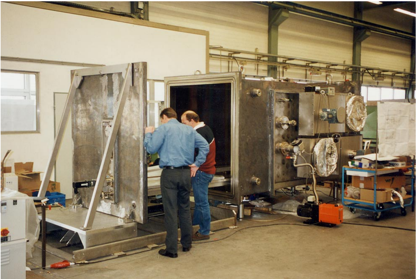
Abbildung 120: EB-Schweißanlage, Aufbau der Arbeitskammer.
