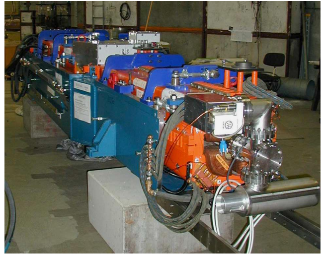
Abbildung 134: Aufbau der Magnetbrücken.
