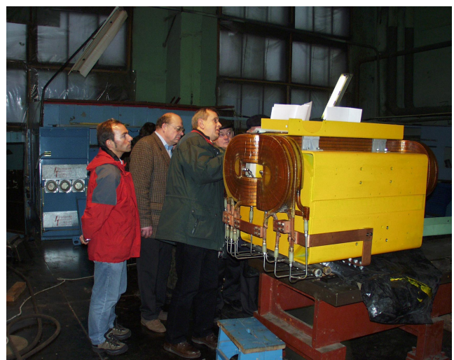
Abbildung 131: Dipolmagnet Typ BP (hergestellt aus altem Typ BT).
