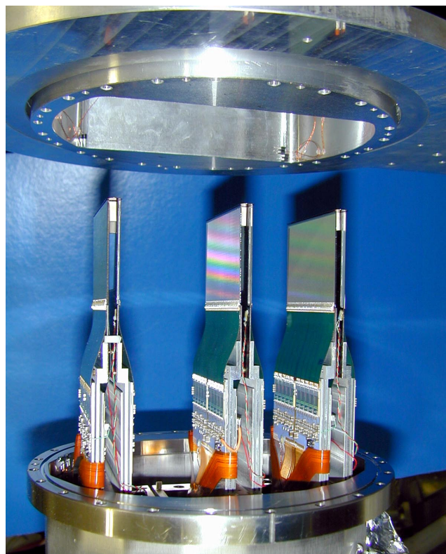
Abbildung 43: Blick auf den äußeren Teil eines Detektortopfes für einen Quadranten der ersten drei Superlagen. Montiert sind sechs Siliziumdetektoren mit ihren Trägerstrukturen und ihrer Ausleselektronik.
