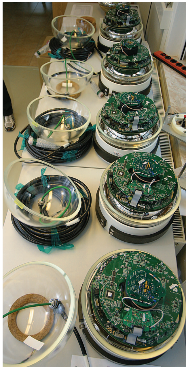
Abbildung 108: Optische Module während der Fertigung.
