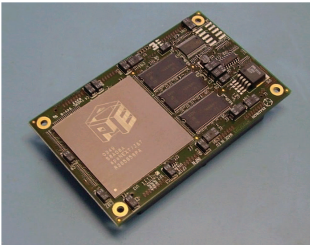
Abbildung 98: Steckkarte eines apeNEXT Knotens mit Prozessor Chip und 256 MByte Speicher. Ein solches Modul hat 1.6 Gflops nominale Rechenleistung bei einer Leistungsaufnahme von weniger als 7 W.
