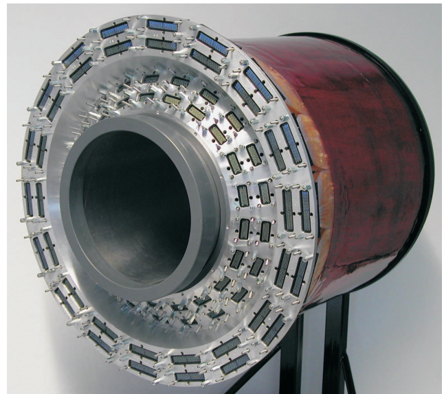
Abbildung 43: Bild vom fertiggestellten Detektor aus szintillierenden Fasern des HERMES Rückstoßdetektors.
