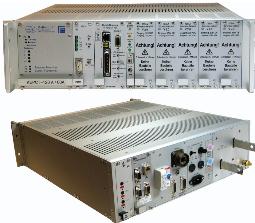
Abbildung 140: Die Front und Rückseite des Korrekturnetzteiles.
