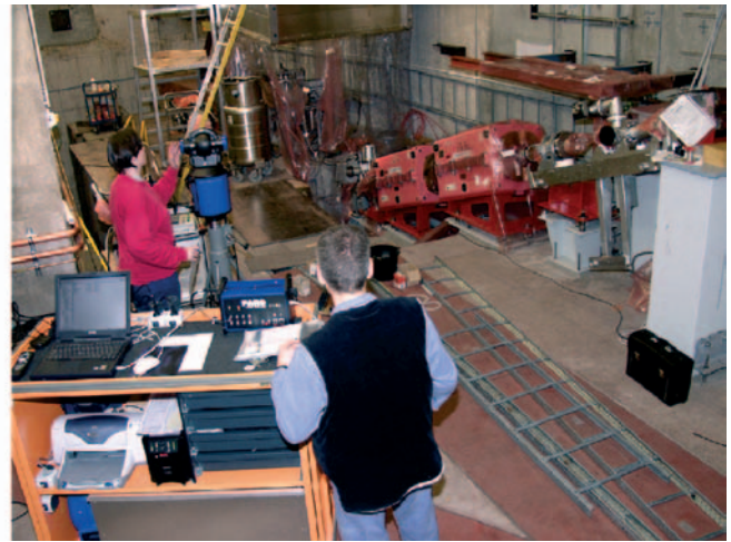
Abbildung 128: Die Undulatoren nach dem Einbau in die Tunnelanlage (links) und die Vermessung des Spektrometerbereiches durch die Gruppe MEA (rechts).
