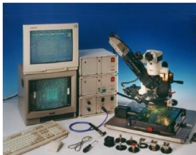
Abbildung 140: „Fineplacer“ zur Reparatur und Bestückung hochpoliger SMD-Bauelemente.
