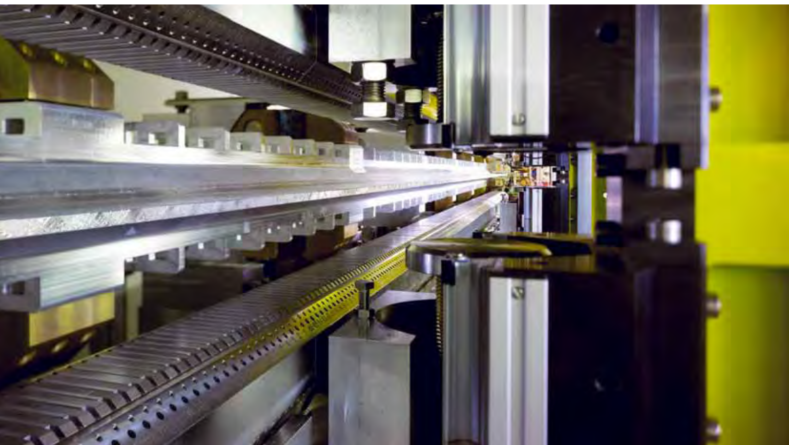
Blick entlang des Strahlrohrs zwischen der Magnetstruktur eines Undulators im Speicherring PETRA III
