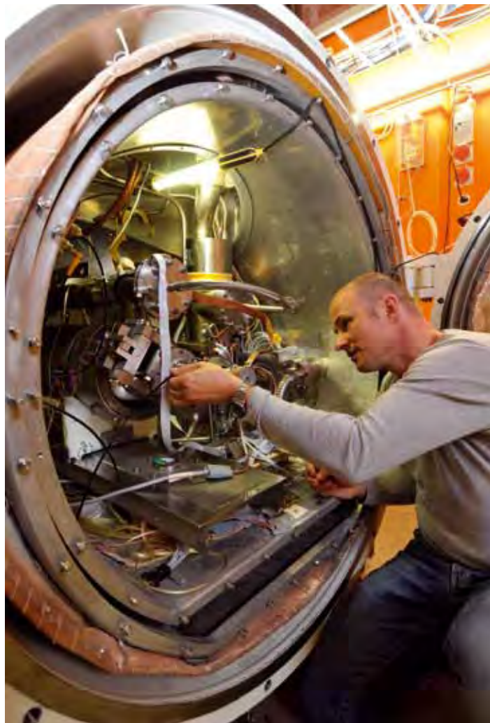
● Vorbereiten der Endabnahmetests der supraleitenden Resonatoren
