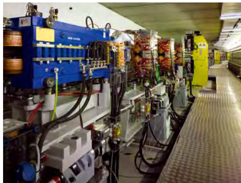
● Blick entlang des Speicherrings PETRA III im Bereich der Experimentierhalle, mit Ablenkmagneten (blau), Fokussierungsmagneten (rot) und Undulatoren (gelb)
