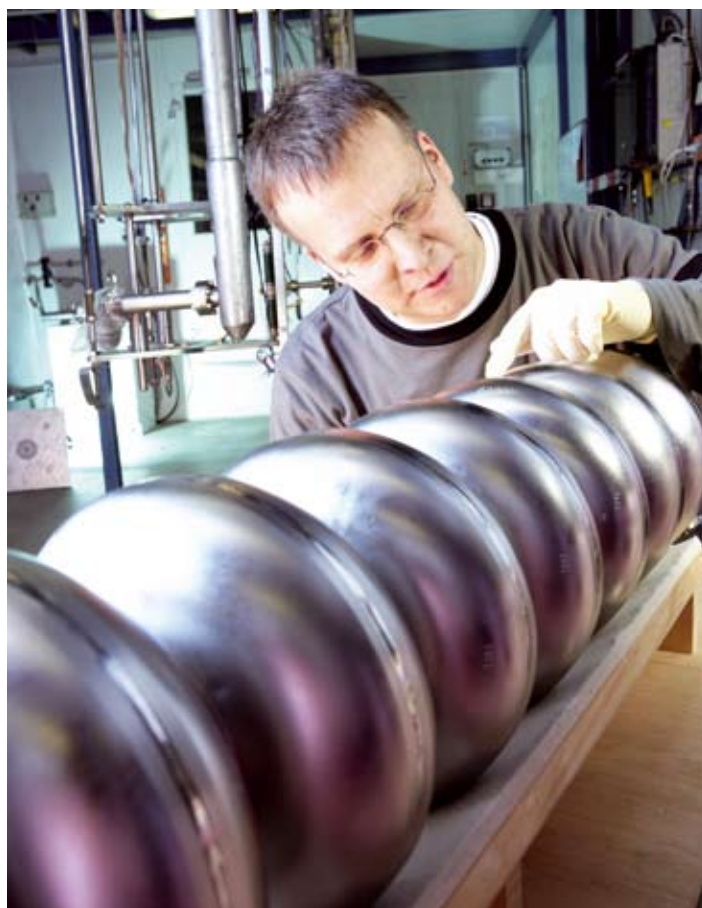
● Inspektion eines supraleitenden Niob-Resonators bei DESY
