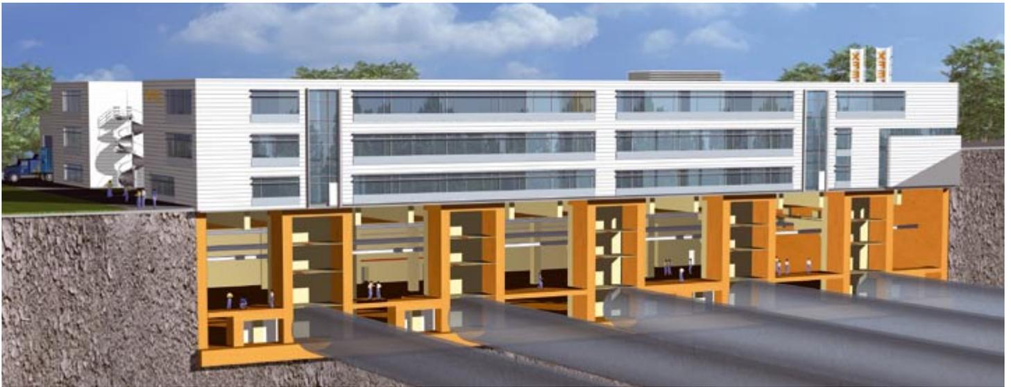
Das Hauptgebäude auf dem XFEL-Forschungsgelände mit der darunter liegenden Experimentierhalle in der Planung: In dieser unterirdischen Halle enden die Photonentunnel, aus denen die laserartigen Röntgenblitze der XFEL zu den Experimentierstationen geleitet werden.
