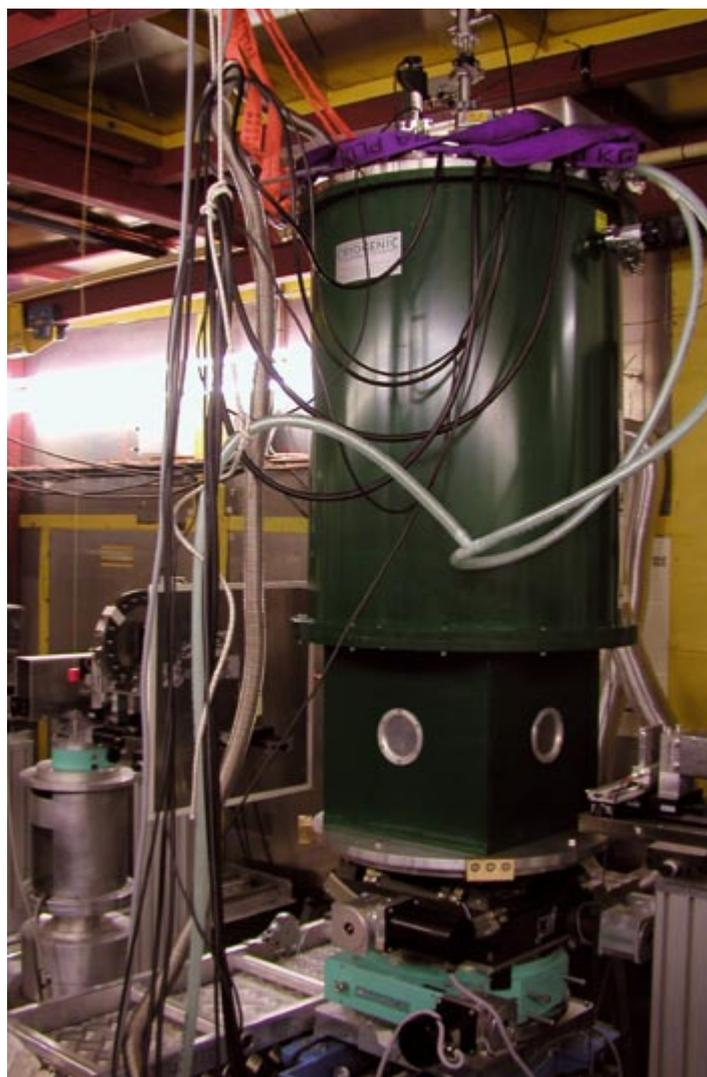
● Der mit einem Hochfeldkryomagneten ausgestattete Messplatz am Speicherring DORIS III
