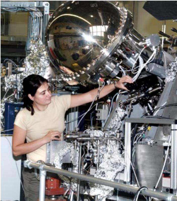
Am HIXSS-Experiment wird das intensive Laserlicht von FLASH genutzt, um katalytische Prozesse an Festkörperoberflächen zu erforschen.
